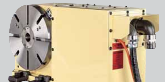
第四軸迴轉工作台(選購配備) 適合多樣化工作加工，例如圓形及角 柱形。
